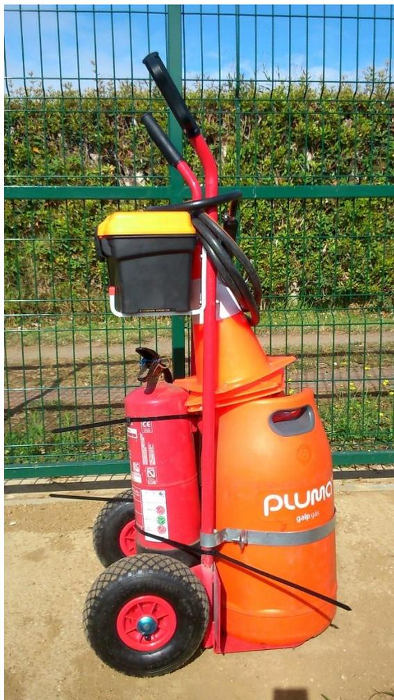
Figura 8.31 – Maçarico a gás utilizado na modalidade de monda térmica.
